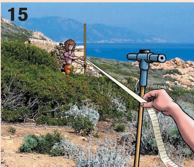
la végétation est trop haute, tu peux rallonger la mire en y fixant la seconde mire. Il est également possible de la doter d'un morceau de tissu pour qu'elle soit plus facilement repérable à travers le viseur (17).
