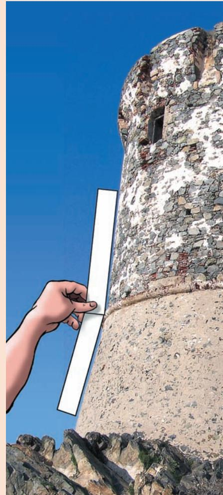
pose les deux bandes de papier à plat et trace sur une feuille de papier l'angle qu'elles forment. Mesure l'angle au rapporteur et reporte la valeur sur la « fiche de relevé des mesures de la tour de La Parata » sur la dernière ligne « Angle de la base par rapport au corps ». La fiche est maintenant complète.
