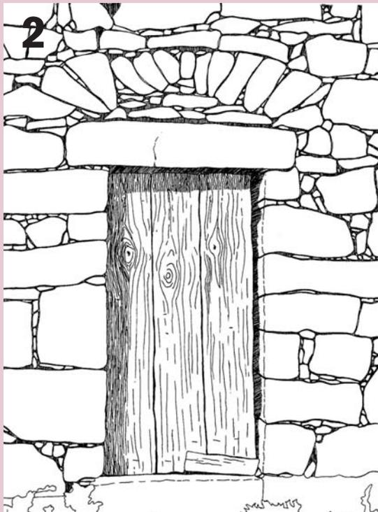
2. Au-dessus du linteau, un arc de décharge le soulage en transférant le poids du mur sur les montants latéraux.
