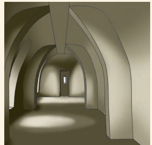
Disegnu di a volta à celu di fornu di un pagliaghju. Ci hè da fà casu à a tamanta fundezza di a custruzzione.
