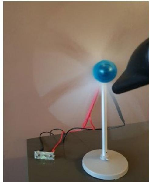
*La LED s'allume lorsque les hélices sont entraînées par le souffle de l'air.*
