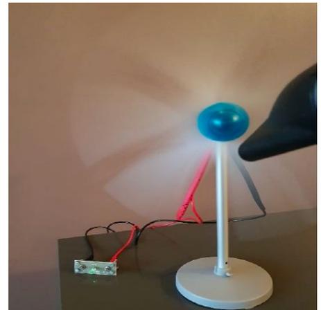
La LED s'allume lorsque les hélices sont entraînées par le souffle de l'air.
