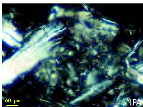
Paquets de fibres d'amiante prélevés dans les déblais derrière la station BP et placés dans une résine (baume de Canada).
