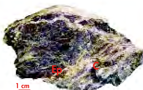
Serpentinite. Ep : épidote, C : calcite.
