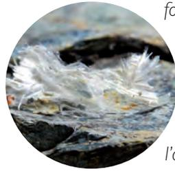
Fibres d'amiante en gros plan.
