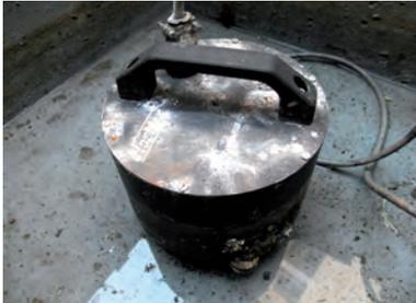
Sismographe\* moderne ou sismomètre
