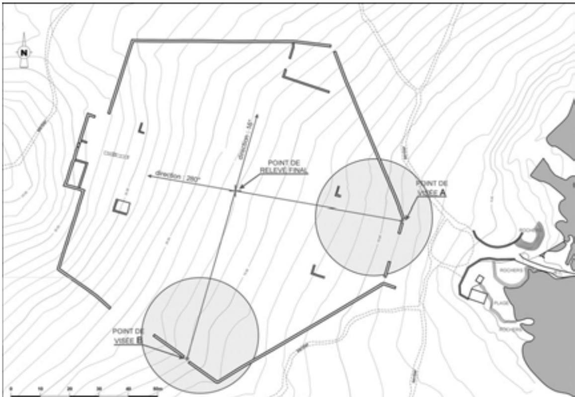
Le travail initial consiste à repérer ces deux emplacements en se servant du plan. Le premier (A) se trouve au milieu de l'ouverture de l'enceinte du lazaret, ouverture située dans l'axe du débarcadère. Le second (B) est placé au milieu de l'ouverture du mur côté sud du pentagone. Ces points de visée seront matérialisés exactement au milieu de chacune des deux ouvertures : une simple division par deux de la mesure de l'ouverture permettra de se positionner.
